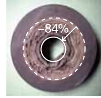
堆積雜質的塑膠管 (水流路面積減少84%)
