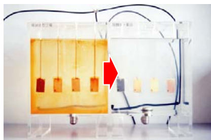
【脱酸素による防錆効果】 水中金属片の経時変化の比較
