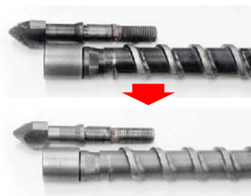
【窒素置換による炭化抑制効果】 スクリュの比較
