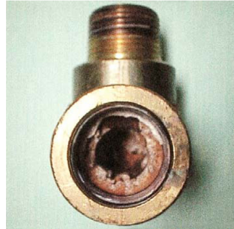
【Fig-01 スケールの堆積した温調機配管】 密閉式クーリングタワー水(130~135°C)を補給水として6か月間使用後の温調機真鍮エルボ断面。
