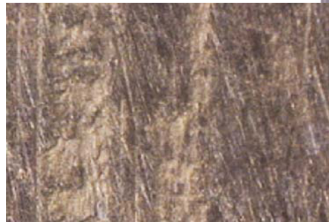
【Fig-02 加工液のみで粗めの砥石を用いて研削したタンゲステン銅】 切りくずの凝着のため表面が汚い。
