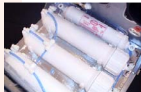
純水逆浸透膜の交換
