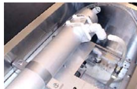
脱酸素セパレータの交換
